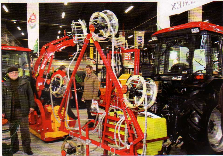
Opryskiwacz elektro-SAD wyposażony w głowice opryskujące Turbair Electrafan
