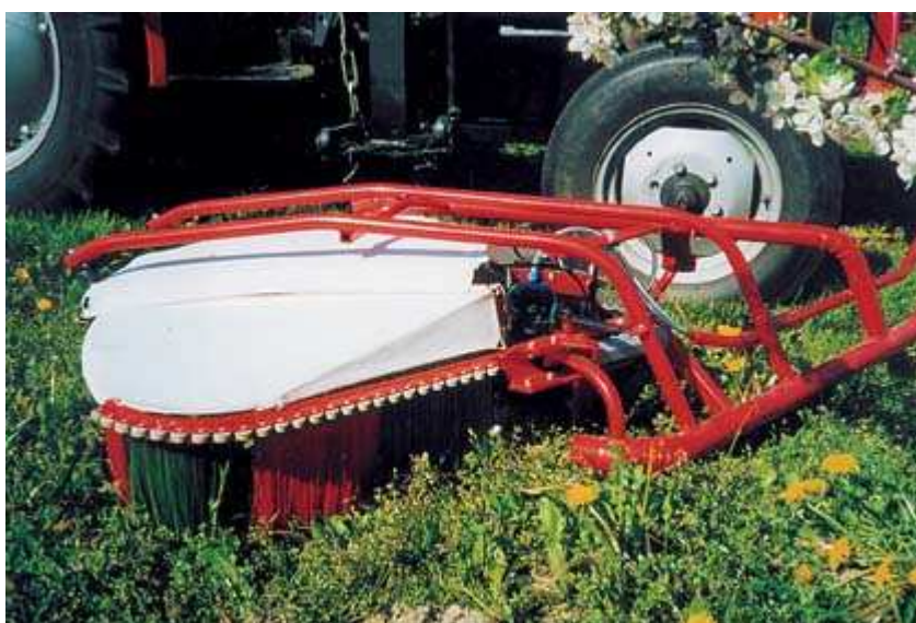
FOT. 3. UCHYLNY ELEMENT OSŁONOWY Z GUMOWYMI ROLKAMI OCHRONNYMI
