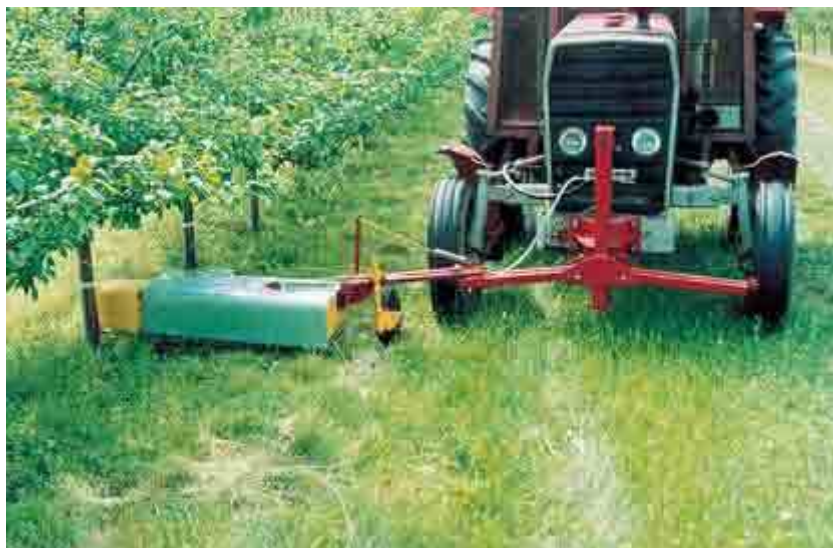
FOT. 1. BELKA HERBICYDOWA Z UCHYLNYM ELEMENTEM OGRANICZAJĄCYM ZASIĘG CIECZY
