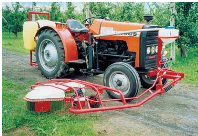
FOT. 5. URZĄDZENIE DO NANOSZENIA GLIFOSFATU ROZPYLACZEM ROTACYJNYM
